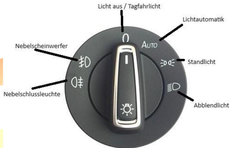
Der Schalter und die Anordnung der Schalterstellungen kann von Hersteller zu Hersteller variieren
